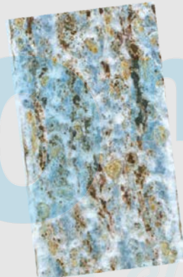
Následné pozinkování 85 μm za 12 týdnů
